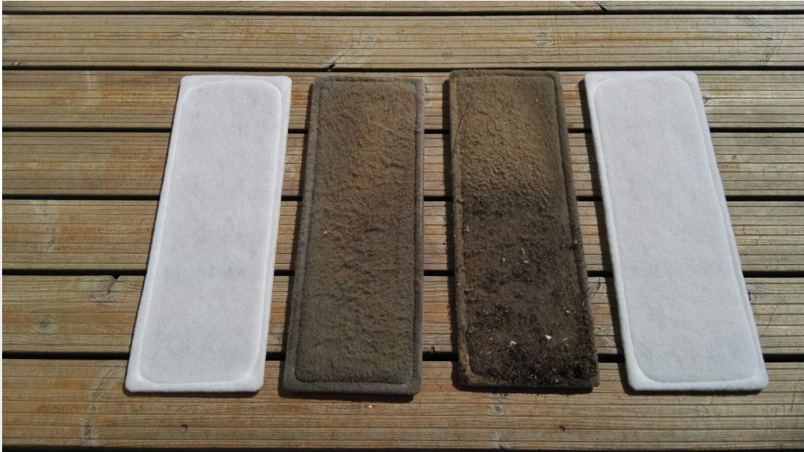
Fuente: Siber. Comparación del estado de los filtros después de unos meses de uso y unos nuevos
